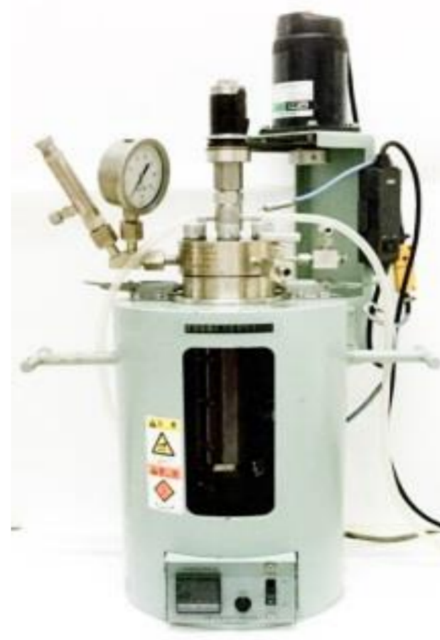
除染システム (Cs分離) の例 (東工大開発)
