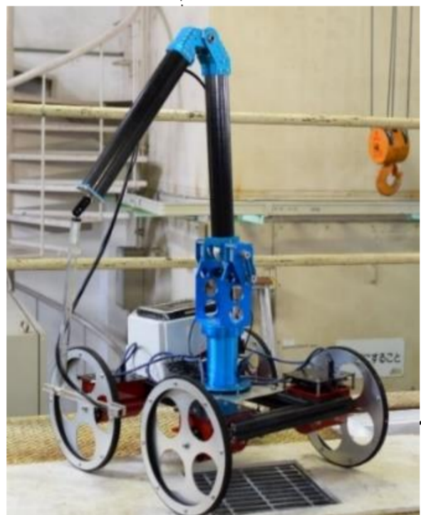
研究用ロボット (遠隔計測ロボット) の例 (東工大開発)
