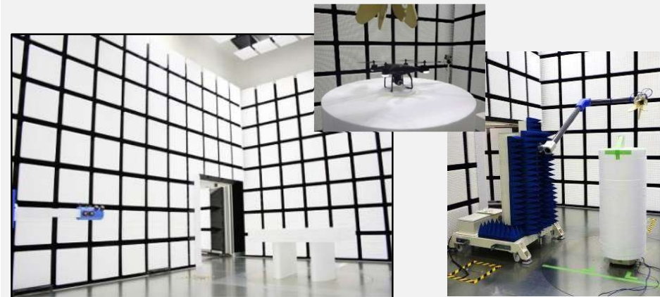
電波暗室・OTA計測システム
